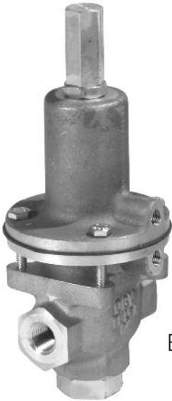
El modelo 1356, un piloto de dos vías, cerrado bajo condiciones normales, que detecta la alta presión bajo su diafragma, la baja presión por sobre este y equilibra el diferencial de presión contra una carga flexible ajustable. Un aumento del diferencial por sobre el punto ajustable del resorte tiende a abrir el piloto.
